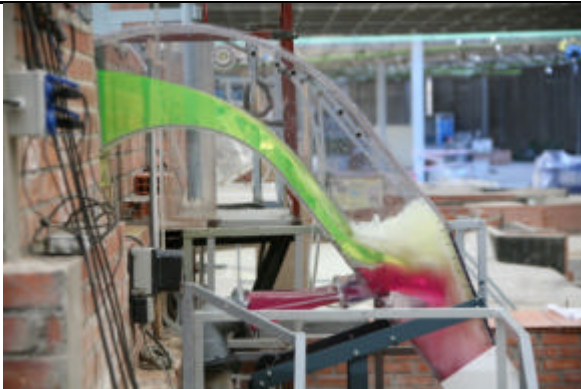
Instalación para experimentación de aliviaderos en sifón
